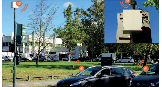
V2I : communication véhicules - infrastructure
